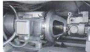
1. A bomba da nossa Injetora de plástico com Bomba de vazão variável tem grande responsividade e ciclo rápido, poupando energia.
